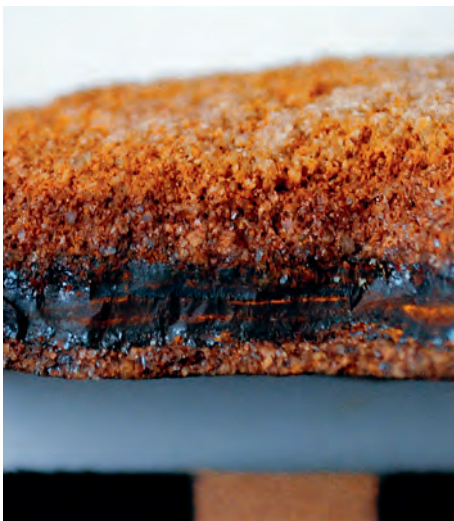
Grès teinté par de l'oxyde de fer avec un filon du même minéral (échelle centimétrique)
