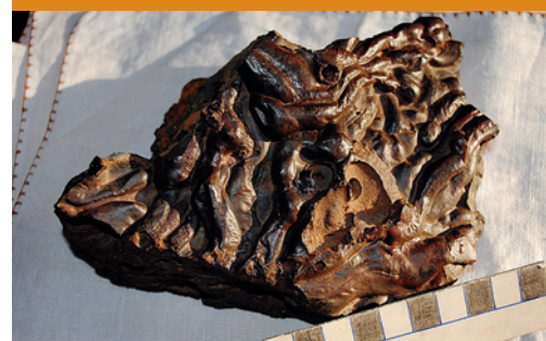
Scorie du Mont Chemin, montrant bien les coulures (éch. centimétrique)
